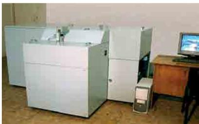
Рис. 2. Общий вид сверхвысокочастотного плазменного комплекса на основе сцинтилляционного анализатора САМ-ДТ-01-2
