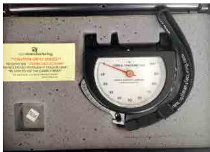
Рис. 6. Тензометр Т5 (производство США)
