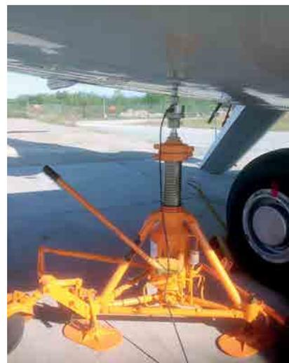
Рис. 5. Элемент измерительной схемы – авиационный гидроподъемник с весовым датчиком системы «Центран»
