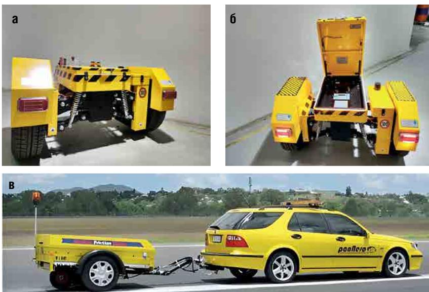
Рис. 1. Отечественная тележка аэродромная тормозная АТТ-3 (1а, 1б) и тележка Т-10, Швеция (1в)
